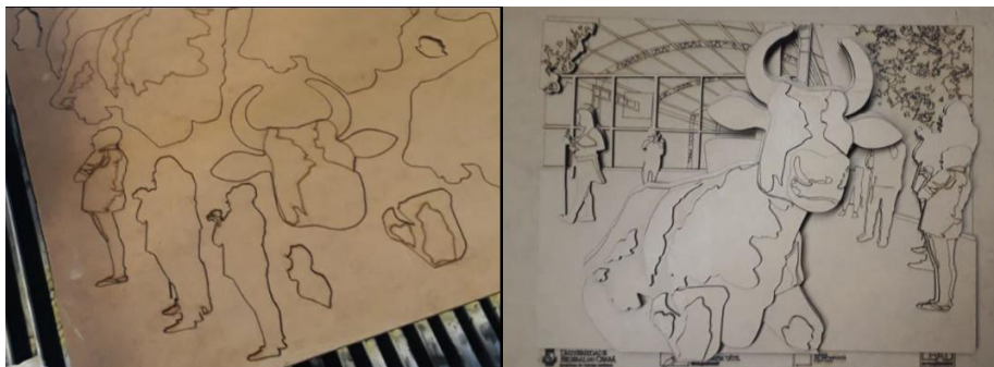
Figura 03 Corte das camadas e sobreposição das camadas cortadas formando a peça final.
