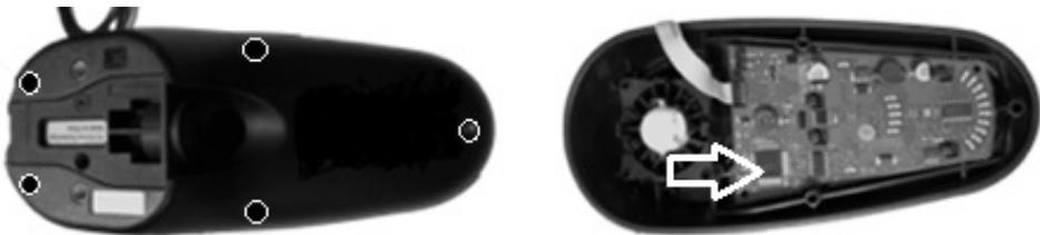
O cabo mini USB precisa passar para o ambiente interno do joystick no mesmo local onde o cabo original estava anteriormente. No lado esquerdo do joystick exibido pela Figura 3(a), foi efetuada a remoção ou quebra parcial da estrutura interna de maneira a comportar o AN por dentro.
