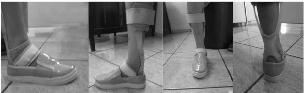
De acordo com as observações dos testes, o projeto e o uso dos materiais utilizados foram eficientes para proporcionar a flexibilidade do produto, porém a quantidade de elastano foi excessiva. Portanto, confeccionou-se outro calçado com 1,5 cm de elastano. A Figura 4 ilustra a paciente fazendo o teste de calçar com total independência, sem nenhum tipo de auxílio tecnológico.
