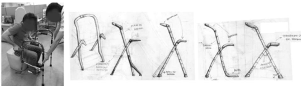
(3) Confeção e testes com protótipos: a fase abrangeu modelagens em softwares Rhinoceros e SolidWorks; impressões tridimensionais de maquetes em escala; confecção de protótipo em tamanho real; avaliações com indivíduos sem mobilidade reduzida e por profissionais de reabilitação consultados na primeira fase do projeto (Figura 03).
