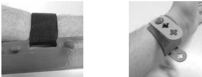
As fitas impressas (Figura 5a e 5b) apresentaram alta resistência, bom acabamento superficial e ainda ofereceram alta adaptabilidade. Além do baixo custo, estas fitas possuem a vantagem de permitir a personalização de geometrias e dimensões, atendendo assim diferentes necessidades específicas.
