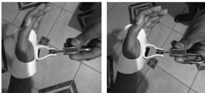
**Figuras 9 e 10:** Teste da adaptação para a abertura e fechamento da tranca de uma porta. Fonte: Acervo pessoal, 2018
