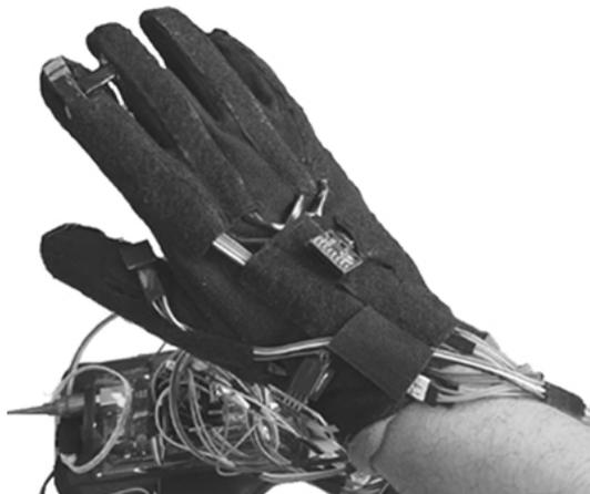
Para a aquisição de sinais dos sensores flexíveis, foram utilizados os canais de Conversores Analógico para Digital (ADC) e tem-se (1), correspondente à tensão resultante do sensor e o valor em (2), resultante da resistência de envergadura do sensor flex:
