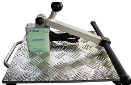
**Figura 3** – Dinamômetro Lombar-femoral da marca EMG System do Brasil utilizado para quantificação da força aplicada e controle do movimento.
