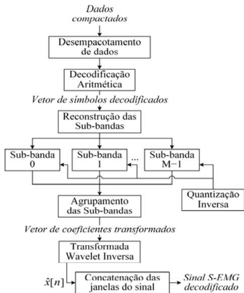
Figura 2: Diagrama de blocos da decodificação de sinais de S-EMG isométricos.
