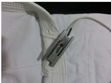
Figura 1: Célula de carga e o kimono adaptado.
