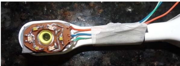
Figura 3: Montagem experimental final do protótipo de Câmera Intraoral por Fluorescência.
