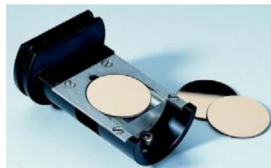
Figura 2: Eletrodo de ouro no prisma.
