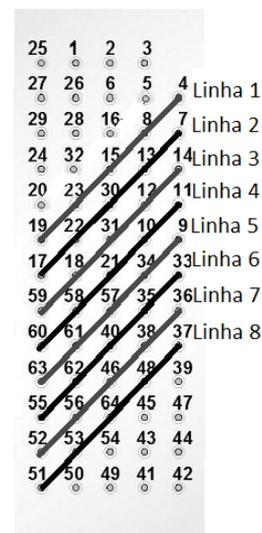
Figura 2: Matriz de 64 eletrodos com a orientação correspondente à direção das fibras musculares do músculo Oblíquo Interno. Esta orientação foi utilizada para calcular 4 sinais diferenciais sucessivos de cada uma das 8 linhas.
