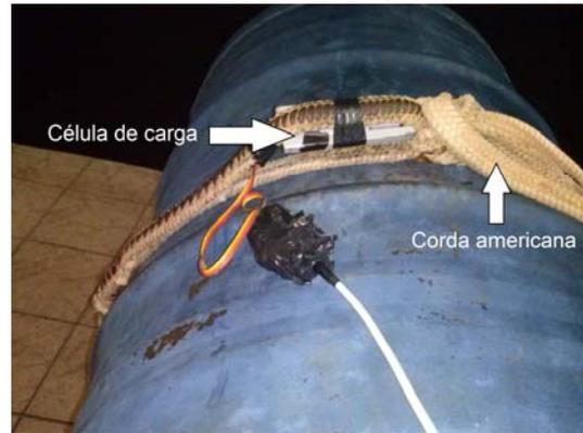
Figura 2: Fixação da célula de carga na corda americana presa ao touro mecânico.
