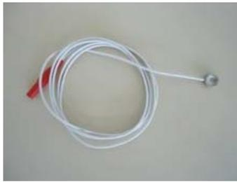
Figura 1: Eletrodo de estanho de 8,0 mm de diâmetro.
