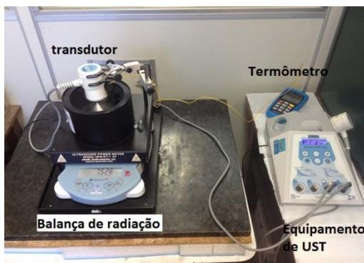
Figura 1: Arranjo experimental para obtenção da potência de saída dos equipamentos de UST.
