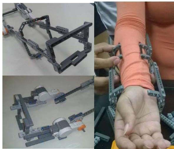
Figura 2: Do lado esquerdo acima e abaixo está o primeiro protótipo do exoesqueleto para cotovelo, do lado direito o protótipo melhorado.
