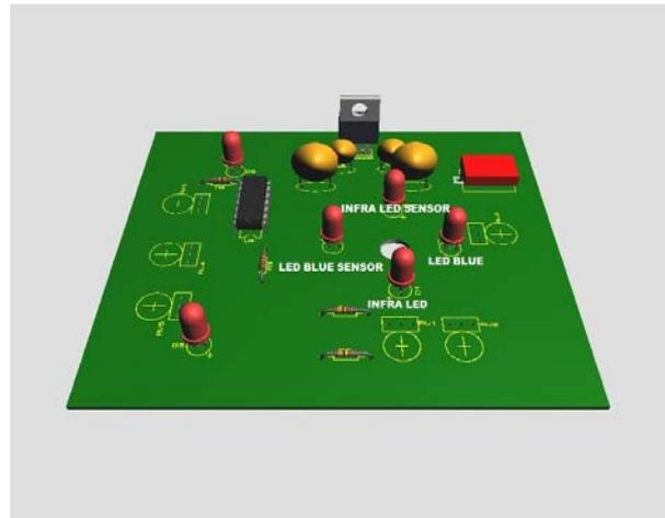
Figura 3 - Layout em 3D da placa confeccionada.
