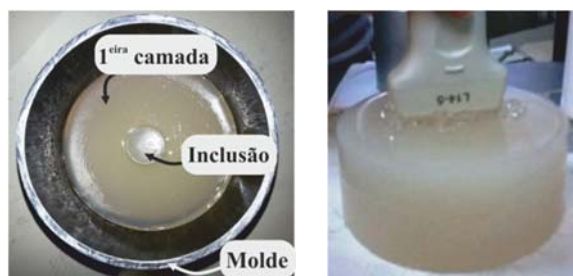
Figura 1: à esquerda, a imagem da primeira camada do phantom de ágar (4%), com a inclusão (6%), no molde de alumínio. À direita, transdutor acoplado ao phantom com as três camadas e inclusão.
