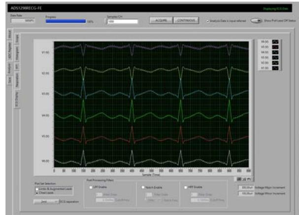
Figura 4: Sinais ECG das derivações precordiais em 120 batimentos por segundo.
