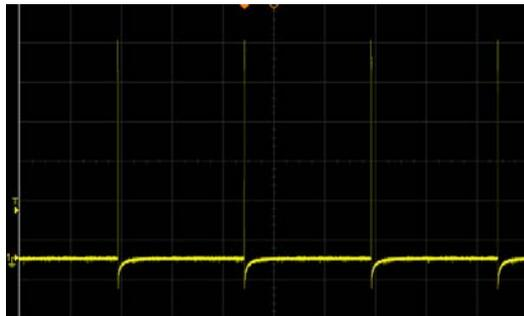
Figura 4: Sinal de estimulação (Escala Vertical: 10V/div, Escala Horizontal: 20ms/div)
