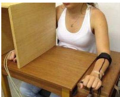
Figura 1 – Tração da célula de carga com o membro superior esquerdo e caixa de madeira para ocultar o membro contralateral (Tarefa 2).
