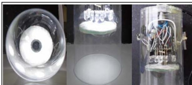
Figura 1: Protótipo (*hardware*) construído objetivando padronizar a aquisição de imagens e reduzir erros relativos a distancia e luminosidade.
