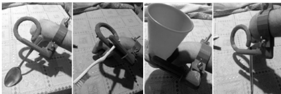
Figura 7: Órtese open-source de mobilidade para de membro superior impressa em 3D. Fonte: Os Autores
