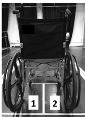
Figura 1: Marcação do piso para posicionamento das CRM durante situações de partida e retomada
