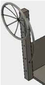
Figura 7: Modelo tridimensional do volante na estrutura da plataforma. Fonte: Autoria própria
